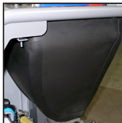
Isolierter Trockeneisbehälter mit einer Kapazität von 23 kg
